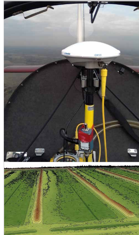
Noch sind die DGPS-Systeme (oben) zu groß für Mini-UAS unterhalb von fünf Kilo Startgewicht. Die unter anderem deshalb zwar mit Ultraleichtflieger, aber handelsüblicher Digitalkamera erfassten Luftbilder der Torfmieten (unten) lassen sich gleichwohl zu einem Orthofoto zusammen fassen und dreidimensional auswerten (mitte).
