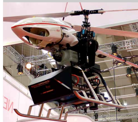
Mit 70 Kilo inklusive photogrammetrischer Kamera braucht das obere UAS-Modell für jeden Einsatz eine individuelle Zulassung und Fluggenehmigung. Das ist jedoch kein Vergleich zu den Rechtsfragen beim Global Hawk, hier in der zivilen Ausführung als Forschungsgerät für die NASA (unten).
