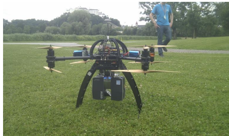
Abb.: Oktokopter der Fa. 4D-IT mit einen FARO-Scanner als Nutzlast.
